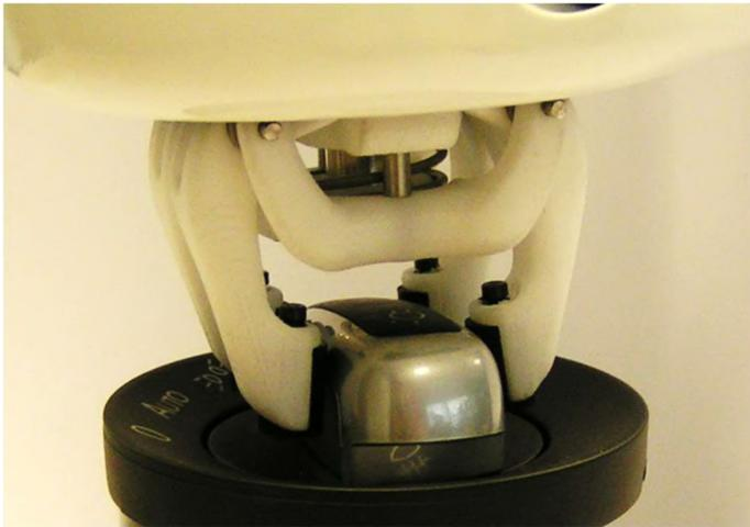
Eine spezielle, in den Greifer integrierte Mechanik verteilt die Greifkraft gleichmäßig auf alle vier Finger des Greifers. Die Finger passen sich beim Schließen des Greifers an die Außengeometrie des Knebels an und stellen dadurch sicher, dass alle Finger einen steifen Kontakt zur Knebeloberfläche aufbauen.
