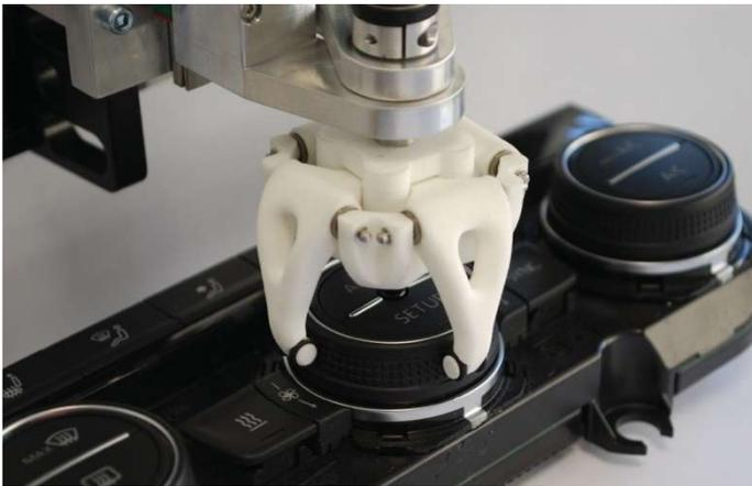
Die Drehhaptikgreifer der DHG3-Reihe wurden speziell für den Einsatz in Drehhaptikmesssystemen entwickelt und hinsichtlich des Massenträgheitsmoments und der Torsionssteifigkeit optimiert und haben sich bereits in zahlreichen Anwendungen durch hohe Zuverlässigkeit und Torsionssteifigkeit bewährt.
